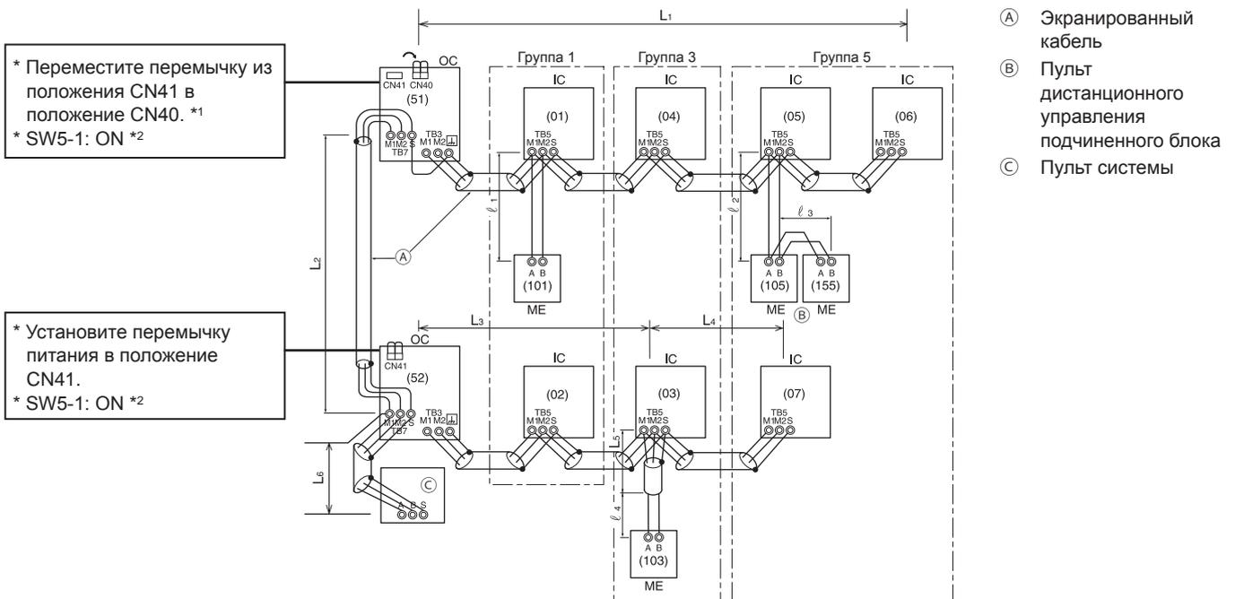
\*1 Если блок питания не подключен к кабелю централизованной системы управления, переместите переключатель из положения CN41 в положение CN40 только на одном внешнем блоке.
