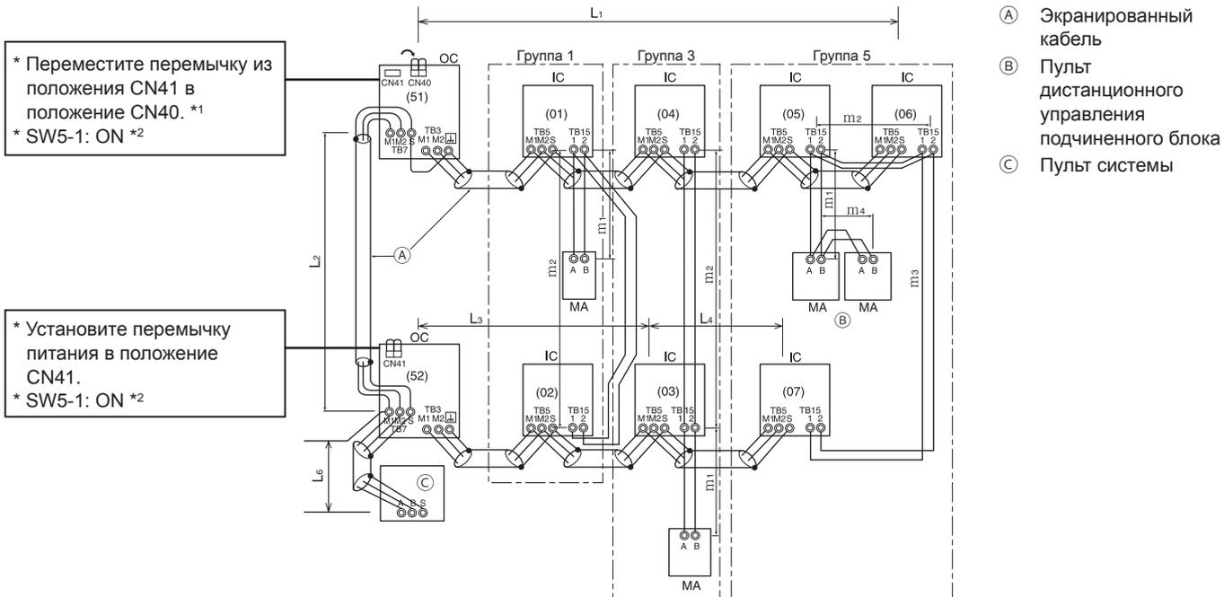
\*1 Если блок питания не подключен к кабелю централизованной системы управления, переместите перемычку из положения CN41 в положение CN40 только на одном внешнем блоке.
