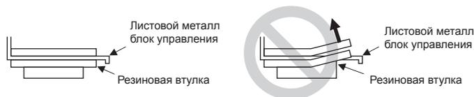
\*3 При закреплении резиновой втулки прилагаемым ремнем не оставляйте зазора между краями втулки.
