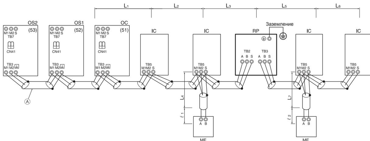
\*1 Клеммы (ТВ3) наружных блоков одной холодильной системы подсоединяются друг к другу последовательно.
