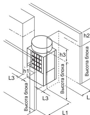
Добавьте разницу превышения максимальной высоты (соответствует «h1» – «h3» на рис.) к L1, L2 и L3, как указано в таблице ниже.
